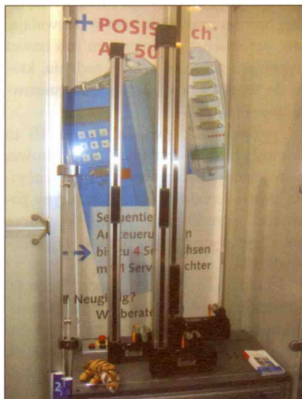
Rys. 1. Kompletny układ serwonapędowy SMS pozycjonujący firmy STÖBER z elektrycznymi napędami liniowymi ELZ firmy MEDAN. Pozycjonowanie odbywa się za pomocą jednej serwooprzetwornicy POSIDRIVE MDS5000, która naprzemiennie (sekwencyjnie) steruje trzema osiami serwo za pomocą POSISwichta
