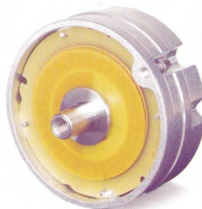
Rysunek.3 Indukcyjny enkoder absolutny z odczytem elektronicznym pozwala obniżyć koszty.
